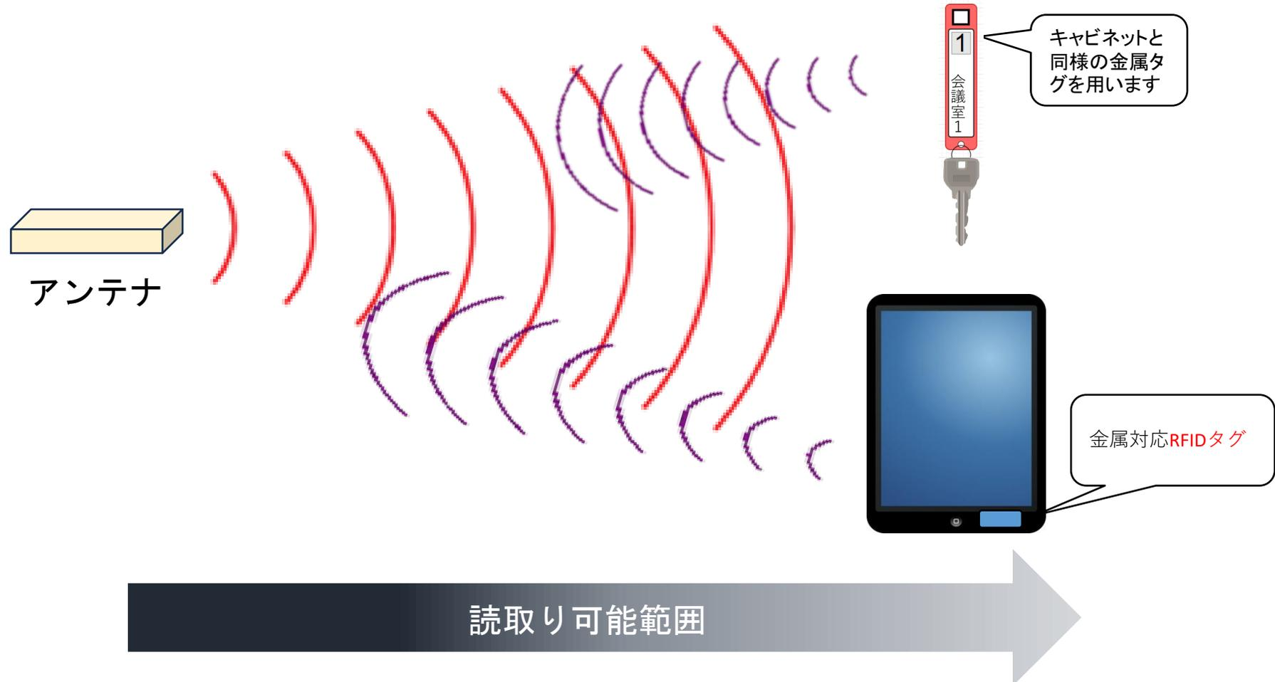
アンテナから出てくる電波が物品に貼り付けたRFIDタグにあたると、RFIDタグが発電します。タグ自らも電波を発信し、信号（ユニークID）が送信されることで、個別認識をおこないます。
